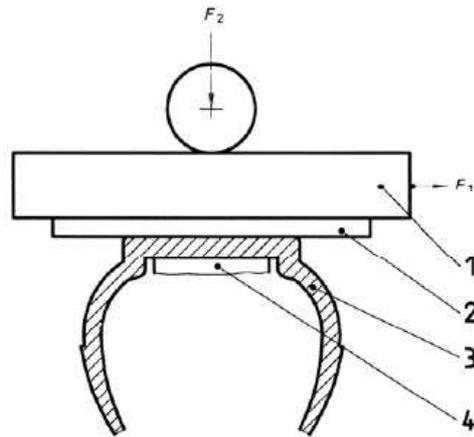
$F_1$ : 수직 시험 하중,  $F_2$ : 수평 시험 하중
