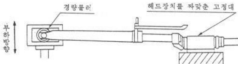
3. 서프펜션부착 앞포크를 **부속서 2 그림 3**과 같이 시험용 허브축을 짜맞춘 상태에서  $70^\circ$  각도로 시험기에 부착하여 허브축 밑에서 수직으로 1.5 kN의 하중을 100,000회 가했을 때 각 부에 이상이 없어야 한다. 또한 최대 진동주파수는 3 Hz로 한다.
