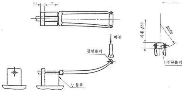
2. 서스펜션부착 앞포크는 **부속서 2 그림 2**와 같이 헤드장치를 짜맞춘 상태에서 수평으로 시험기에 걸고  $\pm 600$  N의 하중을 50,000 회 가했을 때 각 부에 균열, 파손이 생겨서는 안 된다. 또한 최대 주파수는 3 Hz로 한다.
