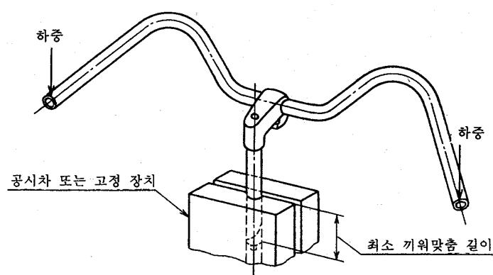
그림 6 핸들 바와 스템의 고정 시험
