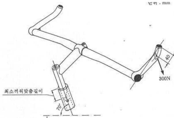
2. 반복 부하 시험 부속서 5 그림 2와 같이 핸들스텝을 최소 끼워 맞춤 길이로 시험기에 고정한 핸들 바에 적절한 측 토크로 바 엔드 바를 부착하고 그 앞끝에서 40 mm의 위치에 250 N 의 하중을 바 엔드바에 대하여 90° 방향에 매번 100회 속도로 좌우 각각 100,000회 가했을 때 핸들 및 바 엔드 바의 각 부에 이상이 발생하지 않아야 한다.
