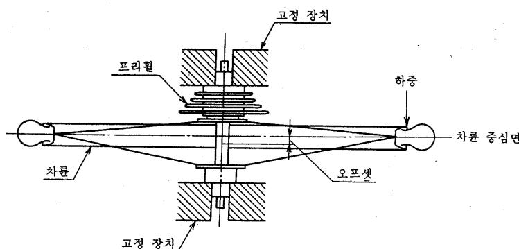
그림 1 바퀴의 정하중 시험
