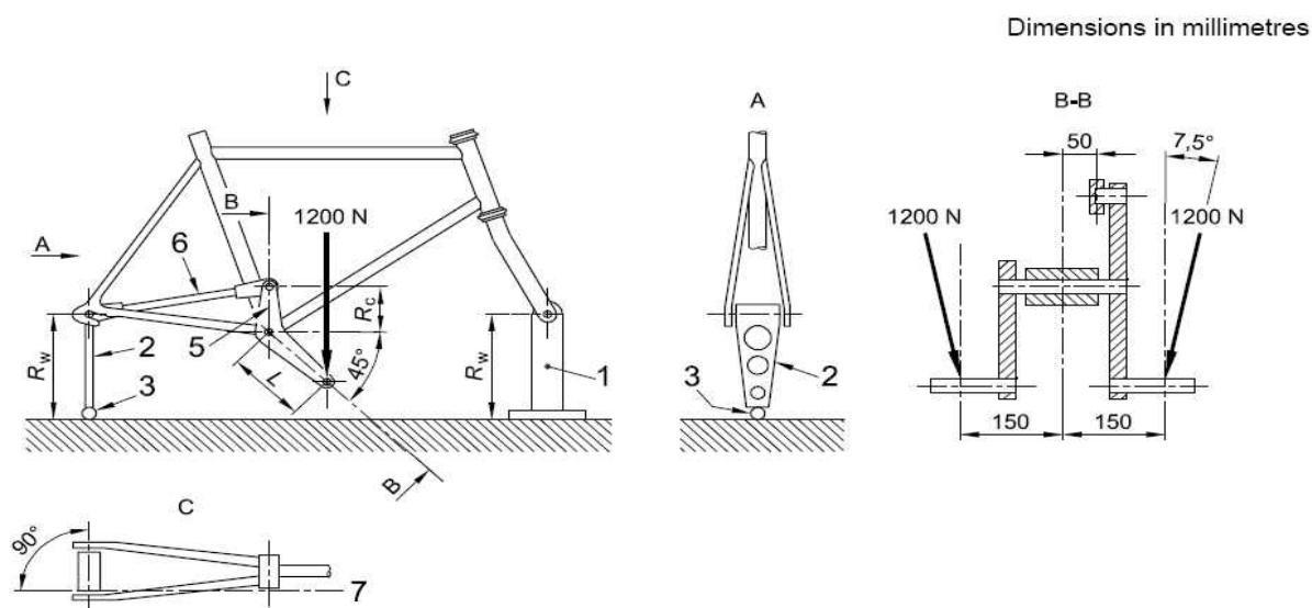
부속서1 그림 1 폐달력을 인가한 프레임 피로시험
