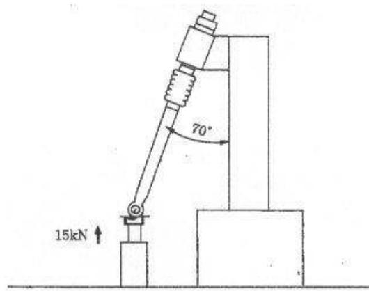
4. 서스펜션부착 앞포크를 **부속서 2 그림 4**와 같이 고정하고 허브축 중심으로부터 100 mm의 위치에  $\pm$  300 N의 하중을 상하로 100,000회 가했을 때 각 부에 균열, 파손이 생겨서는 안 된다. 그리고 최대 부하주파수는 3 Hz로 한다.
