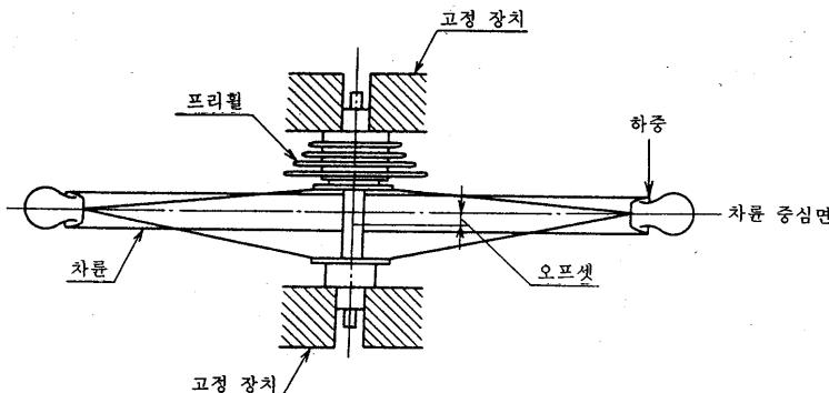
그림 9 바퀴의 정하중 시험
