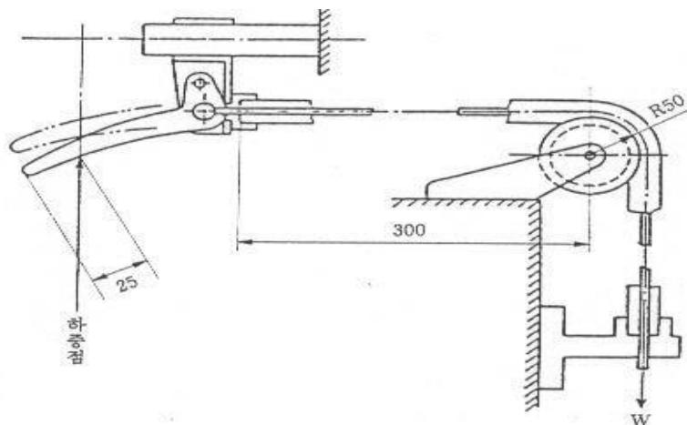
그림 13 브레이크 와이어의 반복강도 시험
