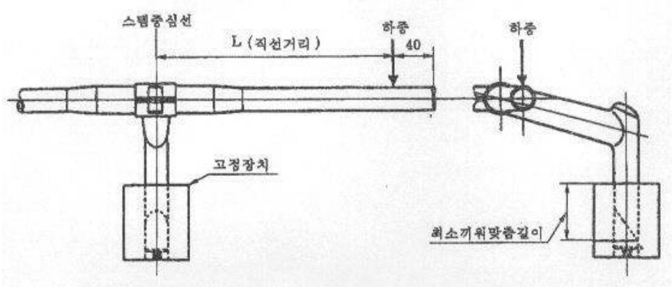
**2. 핸들스템의 포크스템에 대한 고정강도** 핸들스템을 포크스템 또는 그와 비슷한 고정장치에 바르게 짜맞추고 끌어올림 봉을 20 N·m 이하의 적절한 나사조임 토크로 쭈 후 그 상태로 **부속서 4 그림 2**와 같이 바 또는 테스트 바에 40 N·m 이상을 가했을 때 핸들스템은 포크스템 또는 그와 비슷한 고정 장치에 대하여 흔들림이 없어야 한다.
