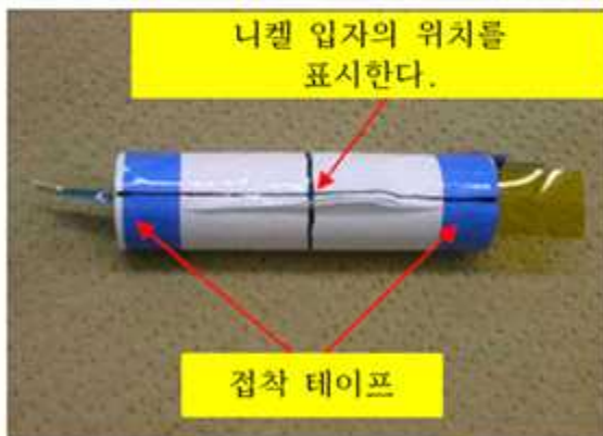
그림 A.6 - 원통형 단전지 해체
