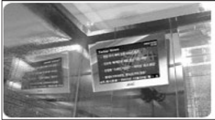
그림7 TFT LCD 디스플레이 및 웹 카메라
