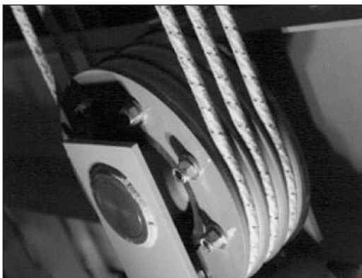
그림3 아이시스와 유로리프트에 적용한 아라미드 로프
