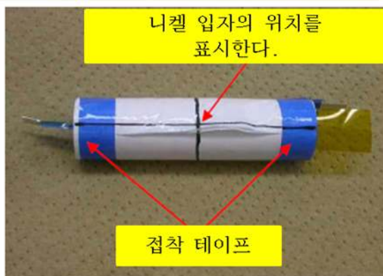
그림 A.5 - 원통형 단전지 해체
