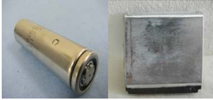
그림 D.2 — 하드 케이스 재질을 갖는 단전지
