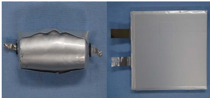
그림 D.1 — 소프트 케이스 재질을 갖는 단전지
