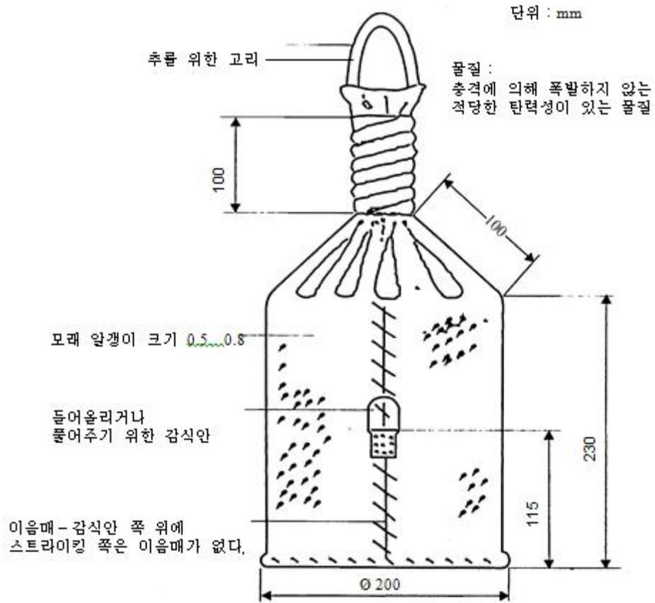
그림 3 충격 부하에 대한 저항을 알아보는 시험용 모래주머니
