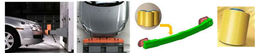
[ 한화첨단소재(주)/현대자동차(주)가 공동개발한 차량용 아라미드 범퍼빔 성능시험장치 및 프리프레그를 이용한 빔 개념도 ]
