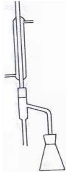
그림4-2 증류식 수분정량장치 (A.O.A.C 형)
